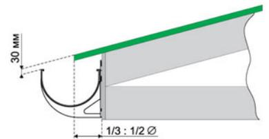
Свес крыши располагается над желобом на расстоянии от 1/3 до 1/2 его диаметра.
